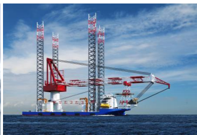
“港航平 5” 自升自航式风电安装平台
