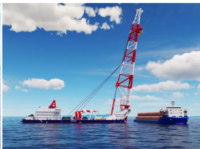
156米动力定位打桩船
